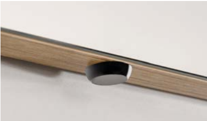
Infrás mozgásérzékelős kapcsoló Funkciója: Bármely világítás be-ki kapcsolása Elhelyezése: Kizárólag natúr tükör élébe Működése: A kéz mozgását érzékeli 3-5 cm-ről, első kézlendítésnél bekapcsol, a következőnél ki.
