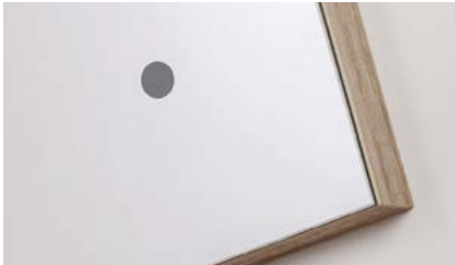
Tükör mögé építhető érintőkapcsoló Funkciója: LT lámpa kivételével, az összes világítás be-ki kapcsolása, és fényerő szabályozása Elhelyezése: Kizárólag natúr tükör felületén Működése: Egy érintésre be-ki kapcsol, folyamatos nyomáskor fényerőt szabályozza.
