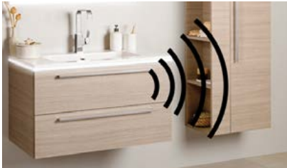
Radaros mozgásérzékelős kapcsoló Funkciója: Radar hullámok érzékelik a mozgást, és fel-le kapcsolja a világítást. Működése: Mozgásra bekapcsolja a lámpát, az időzítő lejártá után kikapcsolja. Elhelyezése: Tükörös szekrényekben, és hangulat világítással ellátott mosdós szekrényekben.
