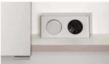
Kapcsoló-dugalj Funkciója: Bármely világítás be-ki kapcsolása Elhelyezése: Kizárólag szekrényes tükör belsejébe építhető be Feszültség: 230 V 16 A Kapcsoló, és dugalj vezeték kiállása: 2X0,75 és 3X1,5
